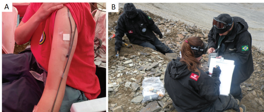
FIGURA 3. Métodos de coleta em campo na Antártica. Métodos de coleta em campo na Antártica. A) Detalhe dos sensores de pele afixados na pele do voluntário. B) Coleta das medidas de temperatura de pele durante o trabalho em campo. FONTE: arquivo pessoal dos pesquisadores do projeto MEDIANTAR.
